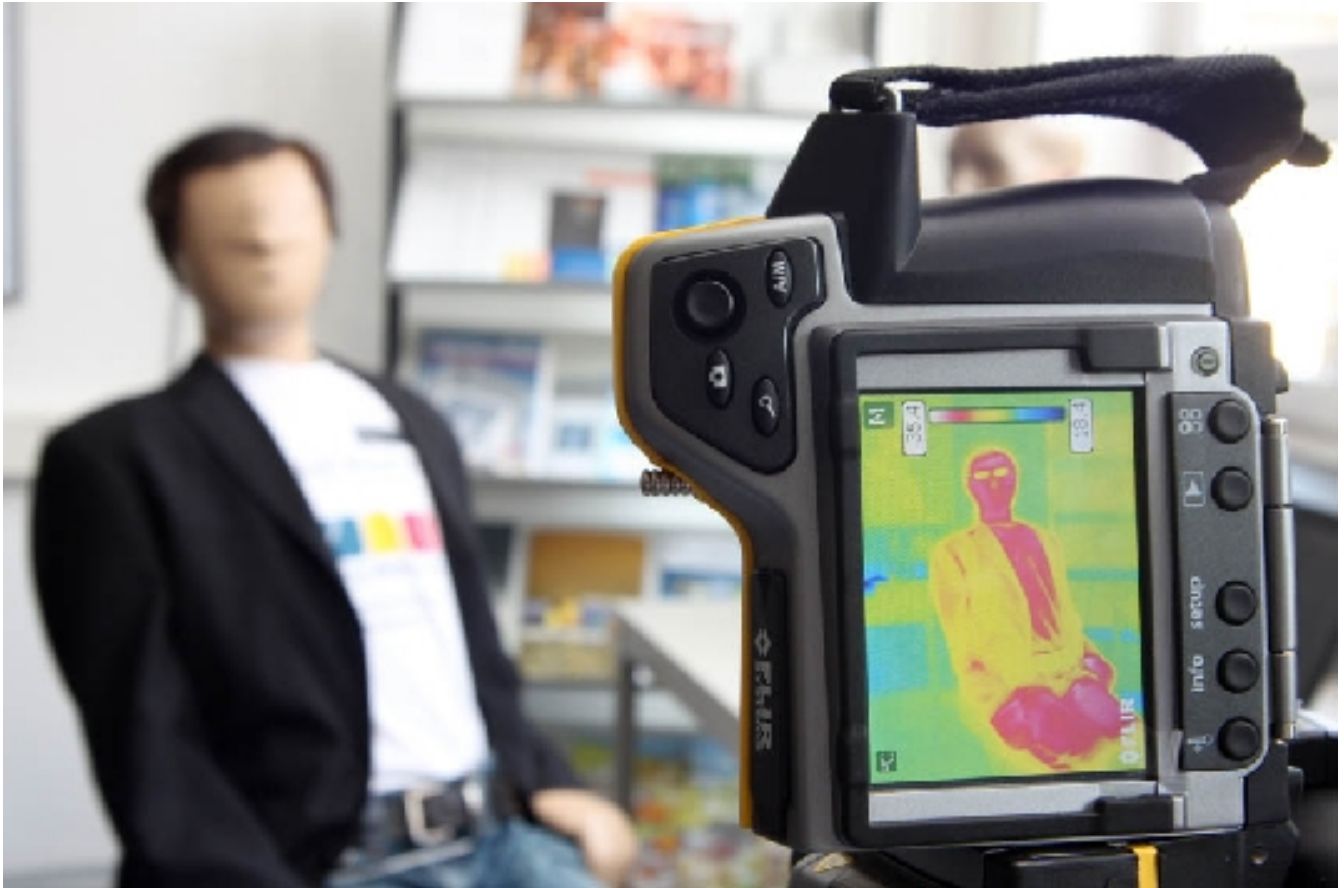
Deutlich sind im Kamerabild die roten warmen und gelben kühlen Körperregionen des mannsgroßen Forschungsgeräts zu erkennen Bauhaus-Universität Weimar
