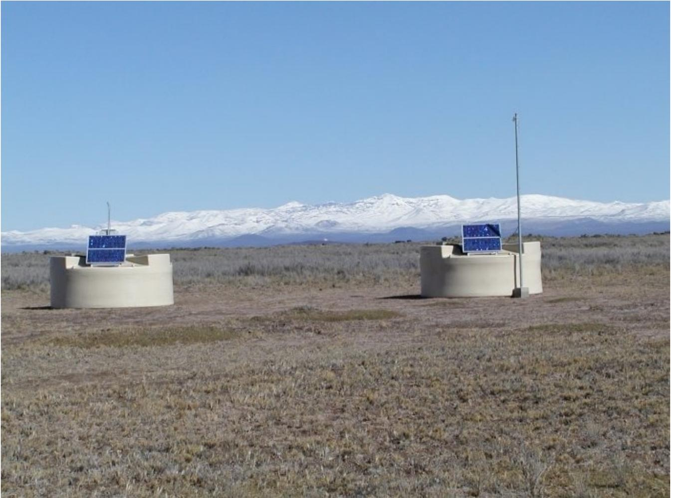
Wassertanks zum Nachweis der Cherenkov-Strahlung durch die Teilchenschauer. Zwischen den Wassertanks ist im Hintergrund vor der Kulisse der Anden das Teleskopgebäude auf Los Leones in ca. 5 km Entfernung zu erahnen.
