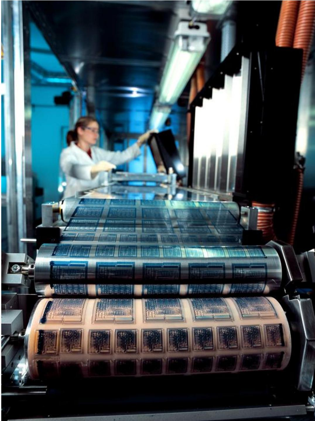
Druckmaschine für elektronische Etiketten
