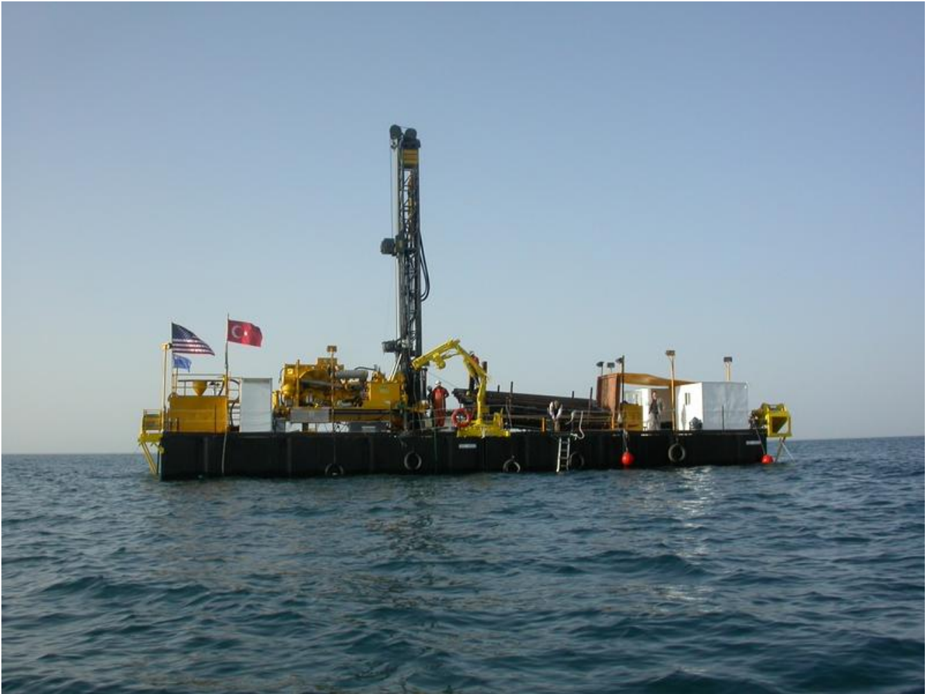
Die Bohrplattform auf dem Vansee. Foto: Uni Bonn
