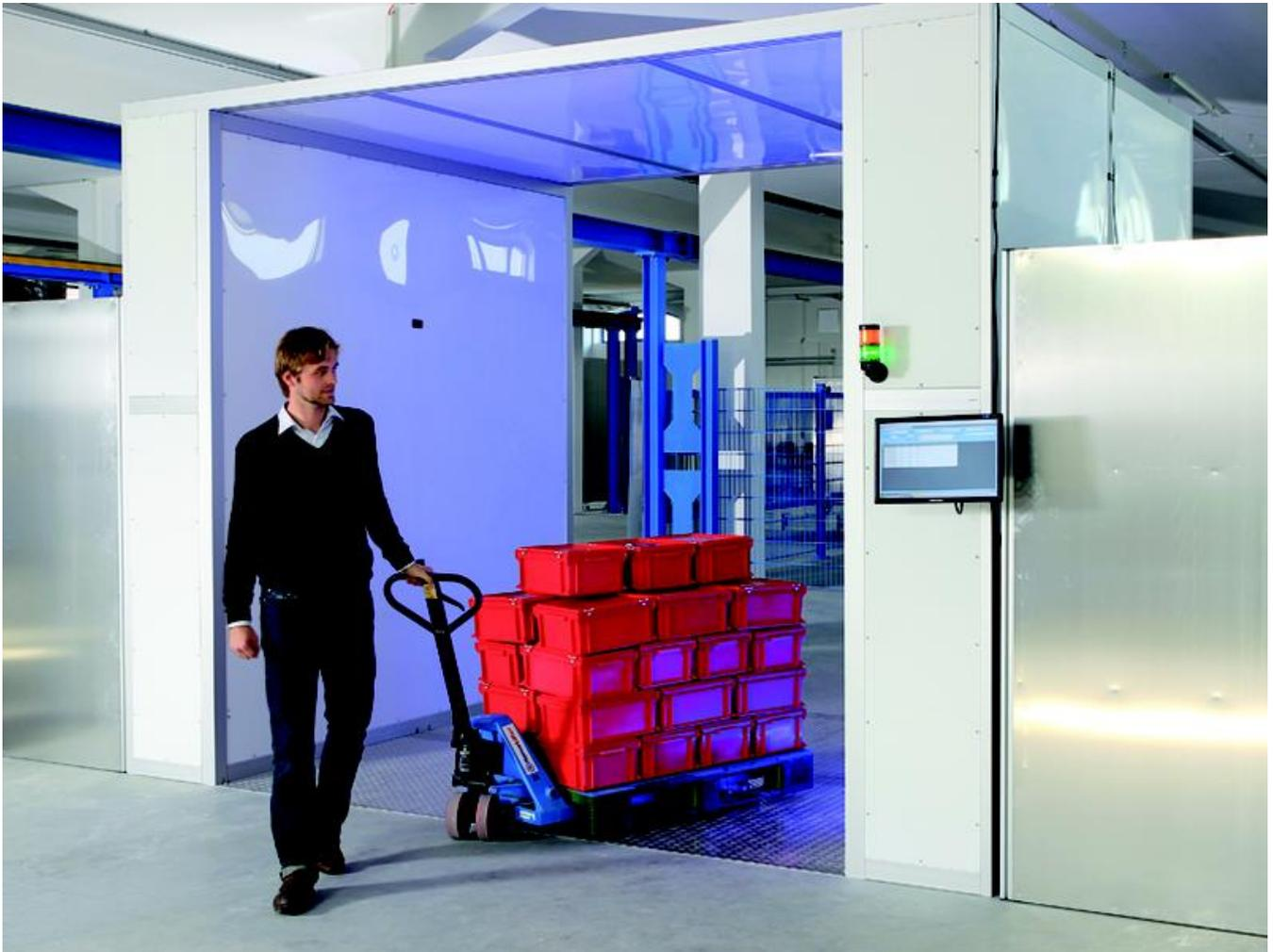
Mit dem neuen RFID-Tunnelgate des Fraunhofer IFF können selbst stark verdichtete Waren mit RFID-Markierung, wie etwa Kleidung, sicher und vollständig inventarisiert werden.
