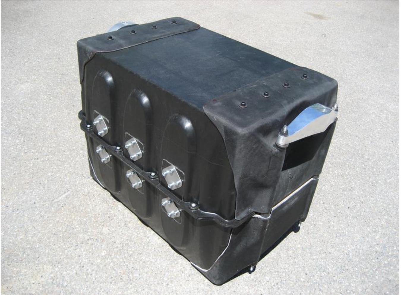
Das Batteriegehäuse aus Leichtbaumaterialien wiegt nur 35 Kilogramm – 25 Prozent weniger als herkömmliche Stahllösungen.
