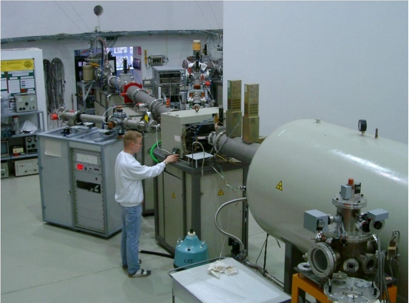
Der Ionenbeschleuniger JULIA der Uni Jena. Mit ihm werden am SFB "Physik und Chemie optischer Schichten" elektrisch geladene Germaniumteilchen in das Halbleitermaterial Siliziumkarbid eingebettet. - Foto: Uni Jena
