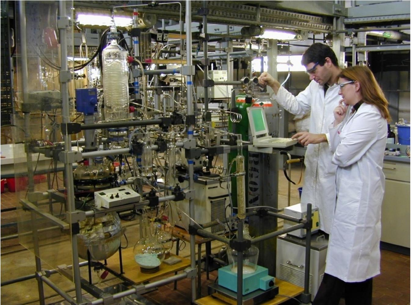
Diese Pilotanlage dient zur Aktivierung von elementarem Stickstoff an Metallsulfiden - ein Projekt des Jenaer SFB "Metallvermittelte Reaktionen nach dem Vorbild der Natur" - Foto: Uni Jena
