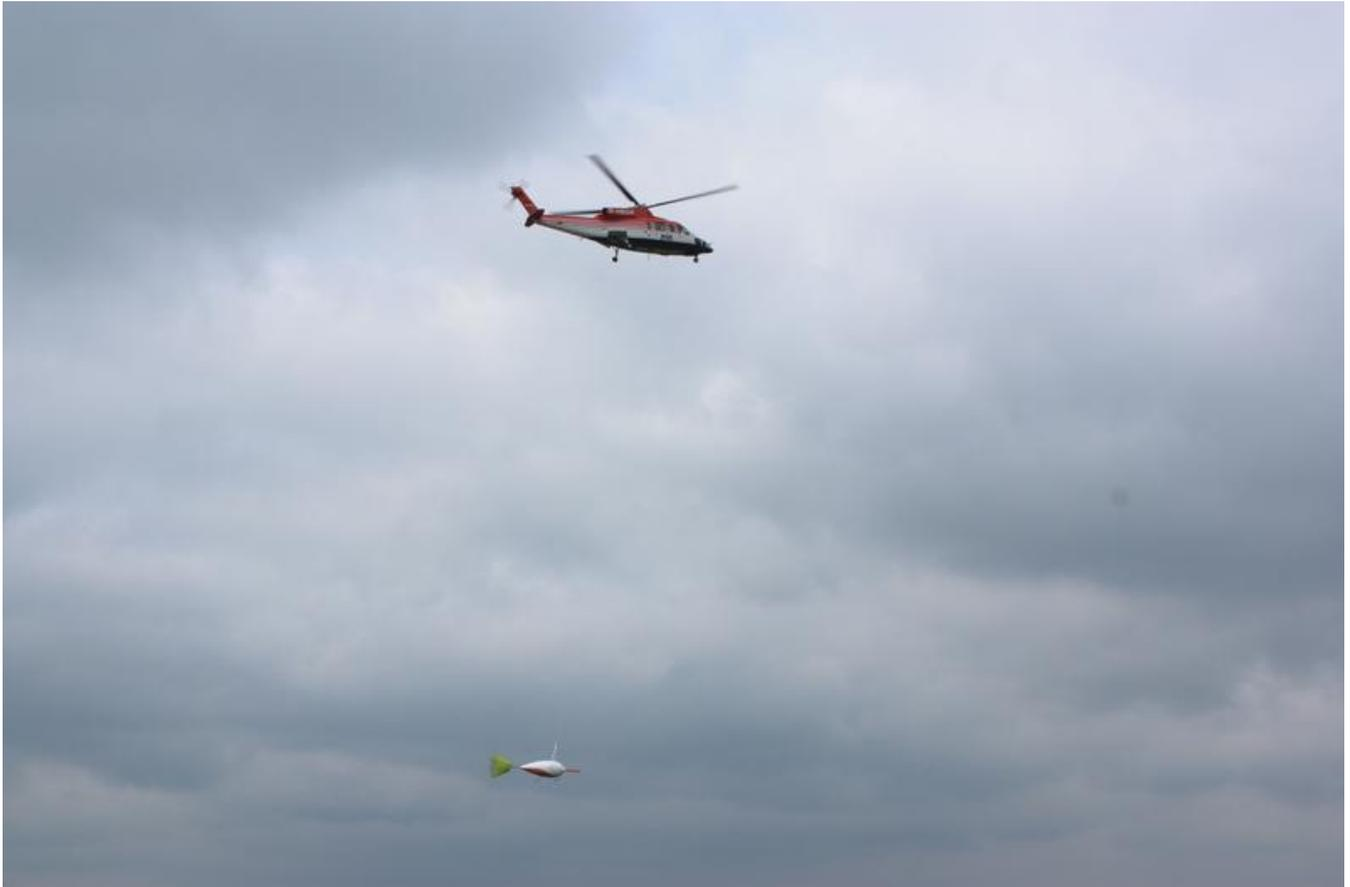
Von einem speziell ausgerüsteten Hubschrauber der Bundesanstalt für Geowissenschaften und Rohstoffe (BGR) wird das Messinstrument in nur 30 m Höhe über den Boden gezogen.
