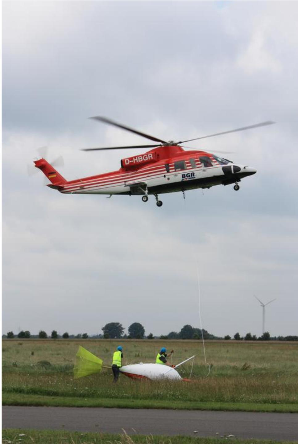
Am Hubschrauber wird das magnetische Volltensorsystem mit den SQUID-Sensoren befestigt.
