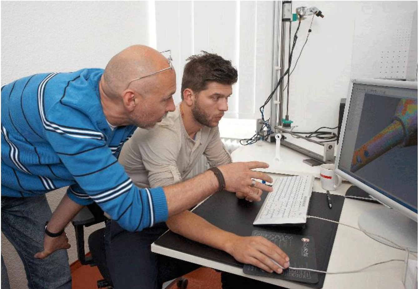
Erfahrungen beim 3D-Scannen: Hat der Laser-Scanner das Projekt abgetastet, entsteht eine Punktwolke am Bildschirm-die Basis für das 3D-CAD-Modell und die exakte Nachbildung des Originals.
