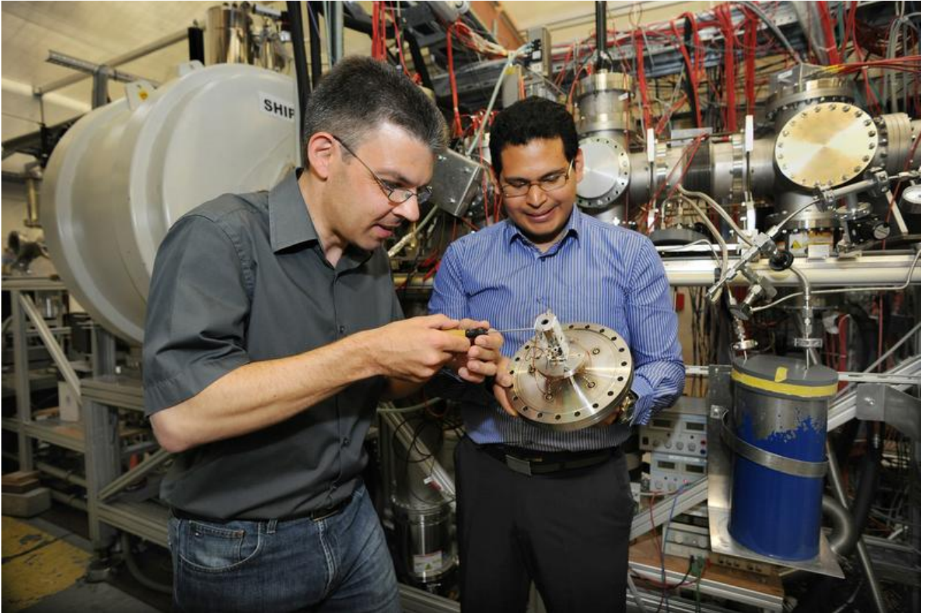
Enrique Minaya Ramirez (r.) und Michael Block mit dem ausgebauten Ionendetektor von Shiptrap. Foto: G.Otto / GSI
