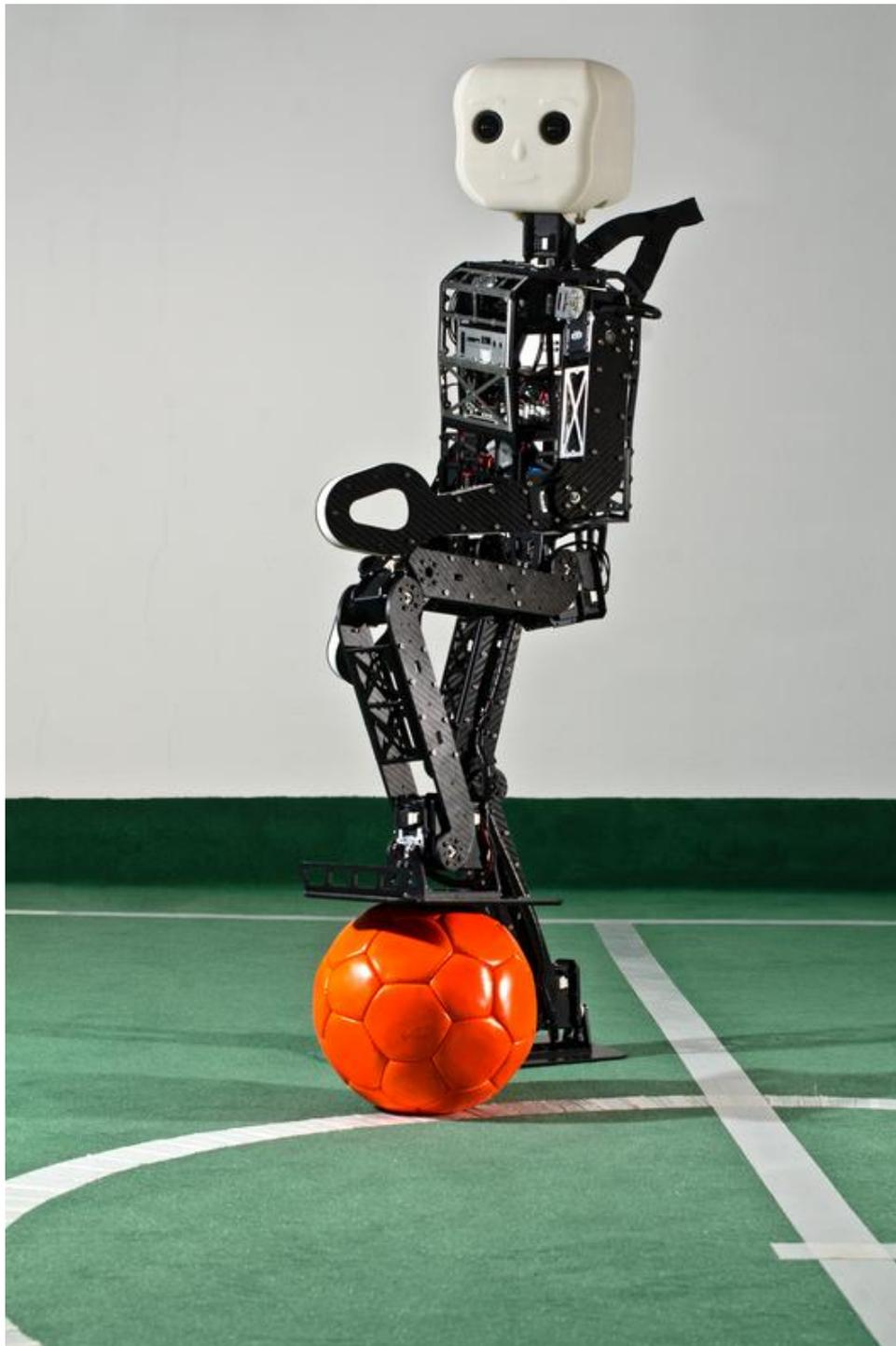
Der neue Fußballroboter "NimbRo-OP" ist rund 95 Zentimeter groß und 6,6 Kilogramm leicht. Insgesamt sorgen 20 Antriebs Elemente und eine hohe Rechenleistung dafür, dass er sehr beweglich und reaktionsschnell ist. Mit seiner speziellen Weitwinkelkamera behält er den Überblick über das Fußballfeld.
