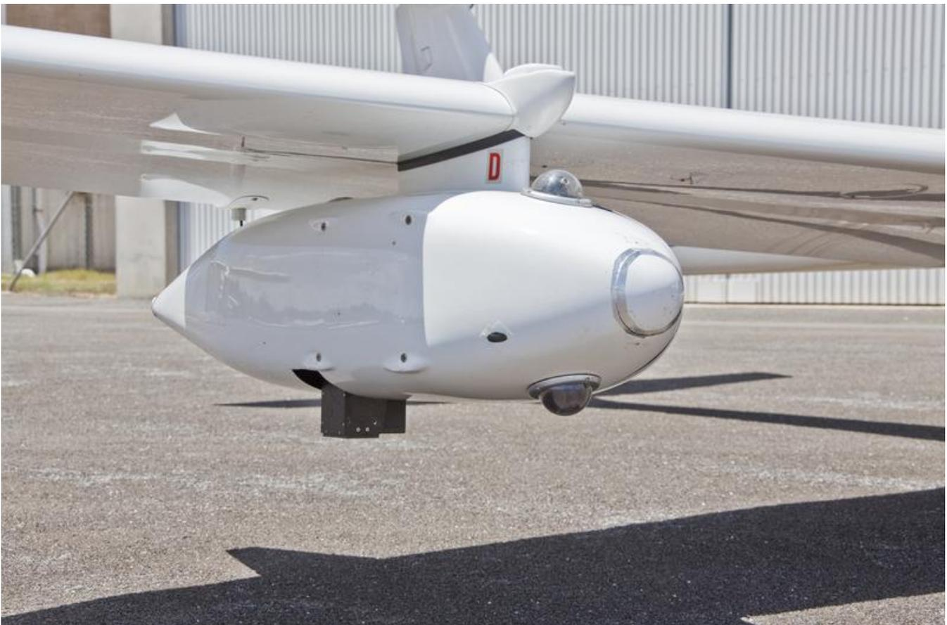
Die Hyperspektralkamera ist unter der Tragfläche des Forschungsflugzeugs angebracht.
