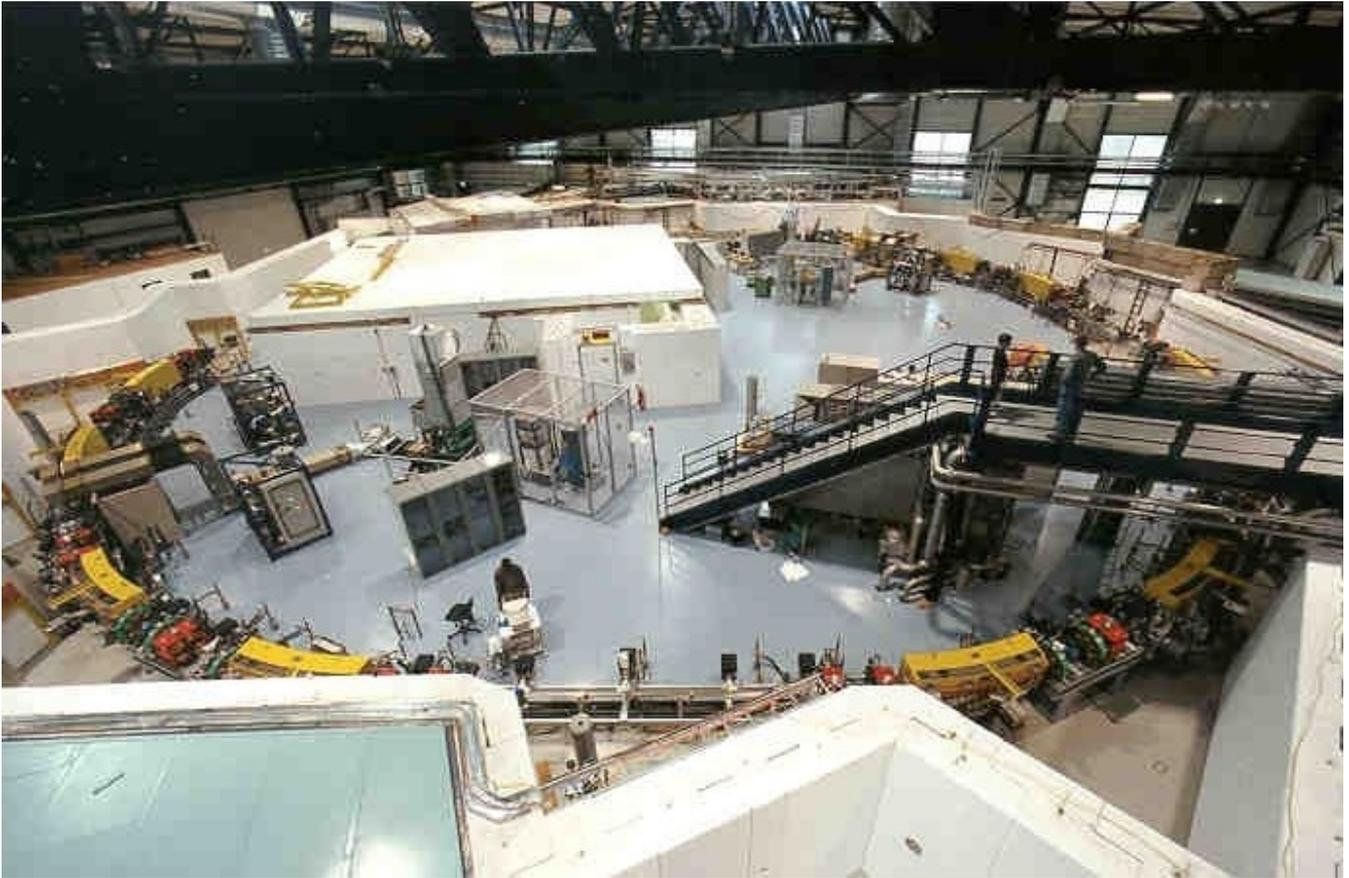
Der Speicherring der Synchrotronstrahlungsquelle ANKA hat einen Umfang von 110 Metern. Durch gelbe Ablenk-magnete wird die Synchrotronstrahlung erzeugt, die in Messhütten außerhalb der sternförmigen Beton-Ummantelung zur Verfügung steht.
