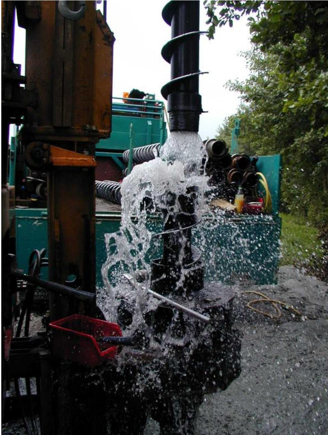
Grundwasserbohrung zur Untersuchung der Salz-/Süßwassergrenze
