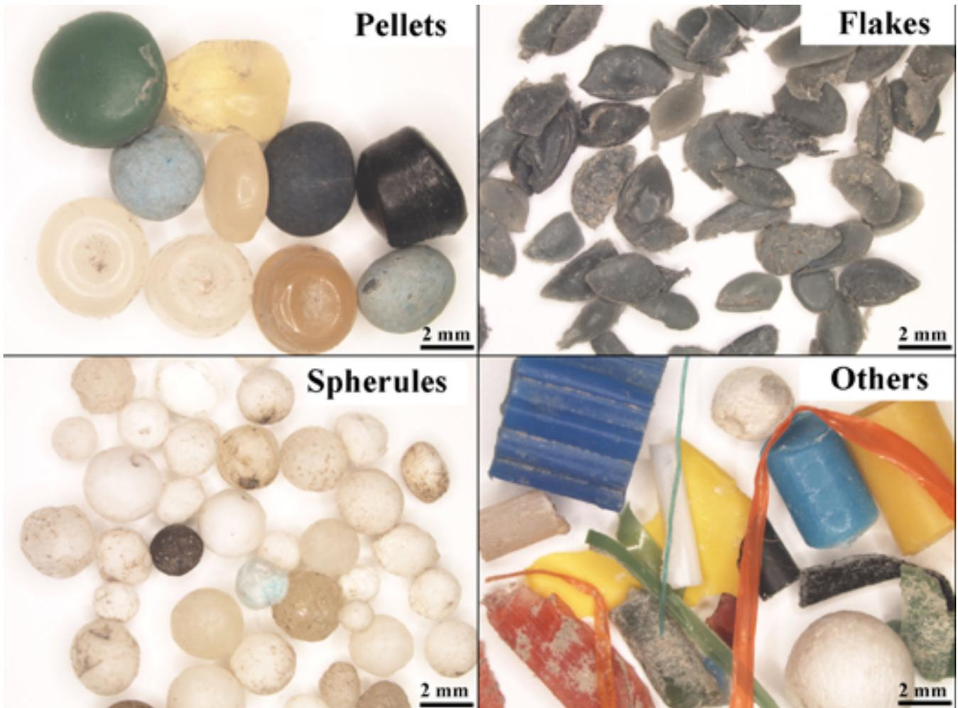
Unterschiedliche Kategorien von Plastik, die in der Donau quantifiziert wurden: Pellets (ca. 4 mm Durchmesser), Flocken (ca. 2,8 mm Länge), Kugeln (ca. 2,9 mm), anderes Material (ca. 15,0 mm).
