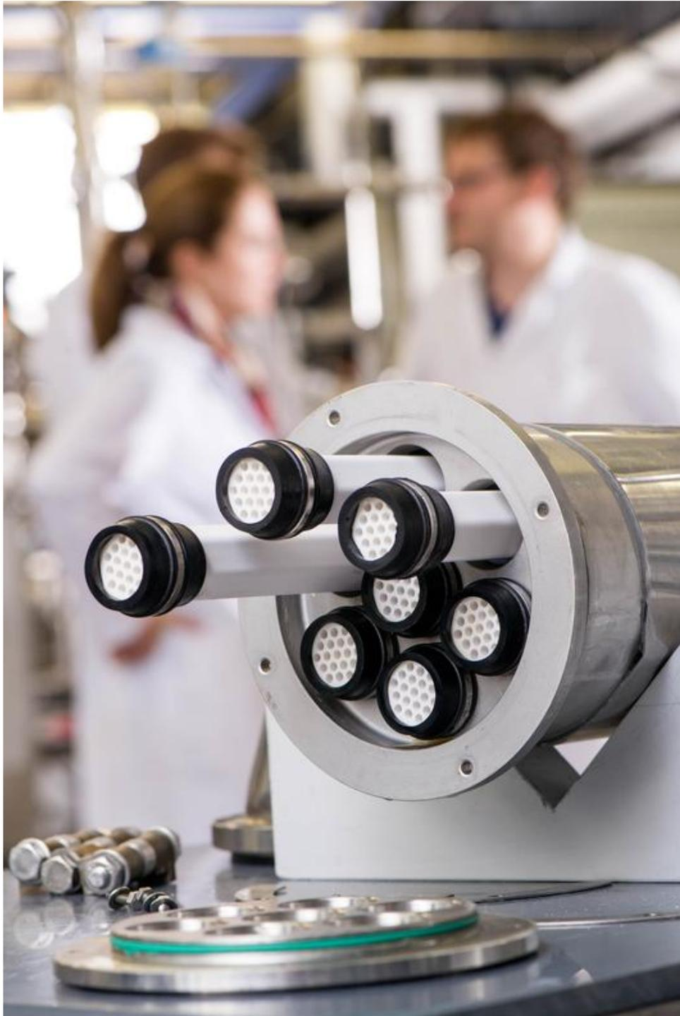
Vorkonzentrieren der Milch: Mithilfe von keramischen Röhrenmembranen werden die Proteine aus der Milch entfernt.
