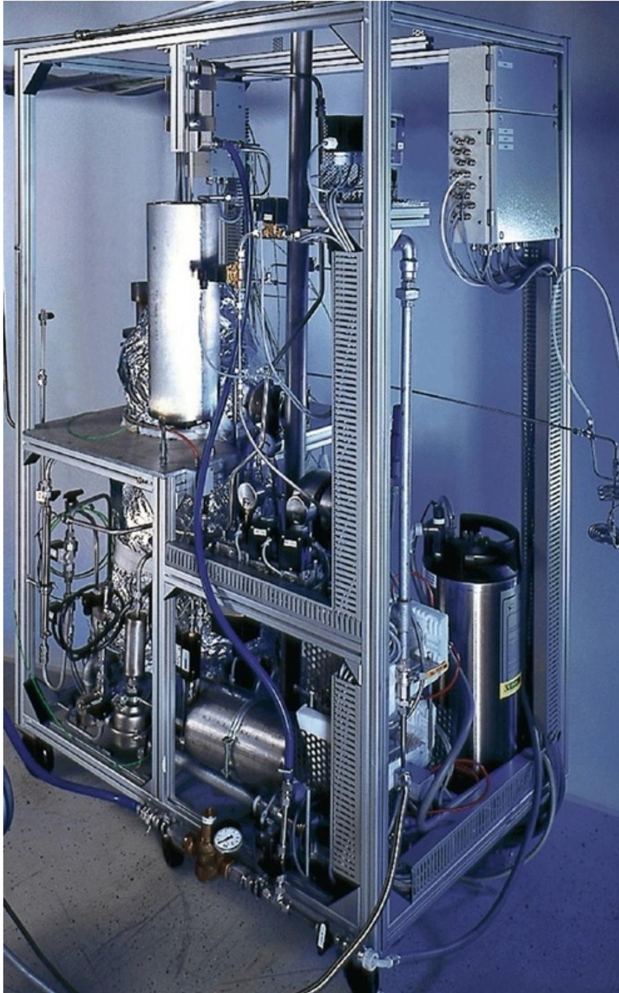
Erdgas-Reformer für ein 2 kWel-Brennstoffzellen-BHKW
