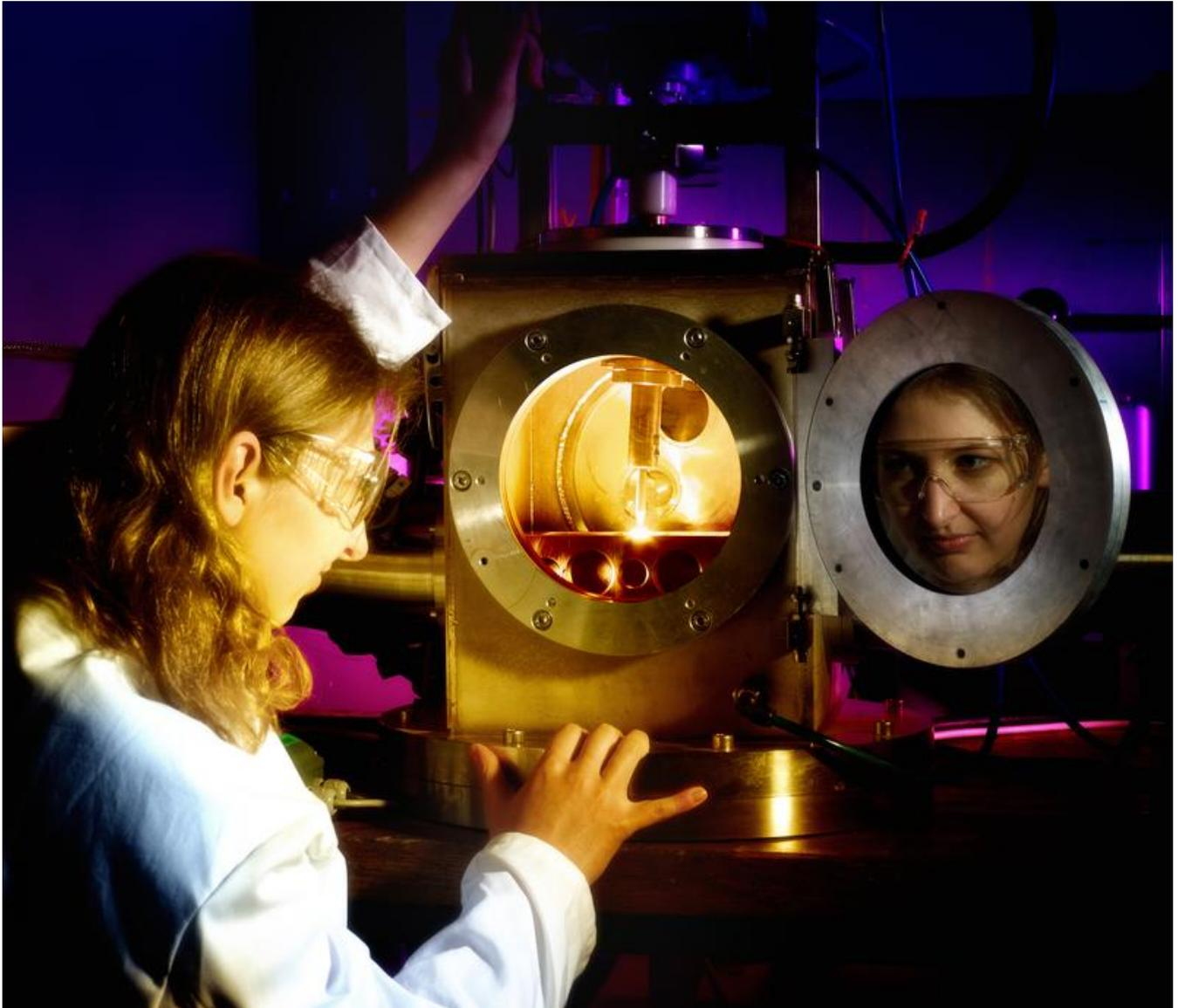
In einem Lichtbogenofen werden die einzelnen Metalle bei Temperaturen bis zu 3000 Grad Celsius zu einer glasartigen Legierung zusammengeschmolzen.
