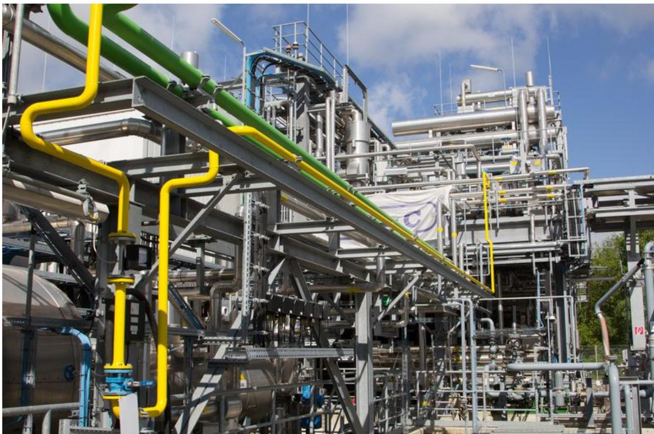
Anlage zur Herstellung von Benzin aus Synthesegas
