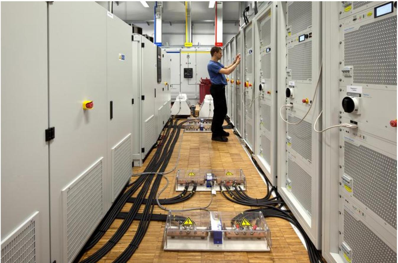
Prüfaufbau im TestLab Power Electronics des Fraunhofer ISE zur Prüfung mit PV-Generator-Simulator (rechts) und Prüfling (links).
