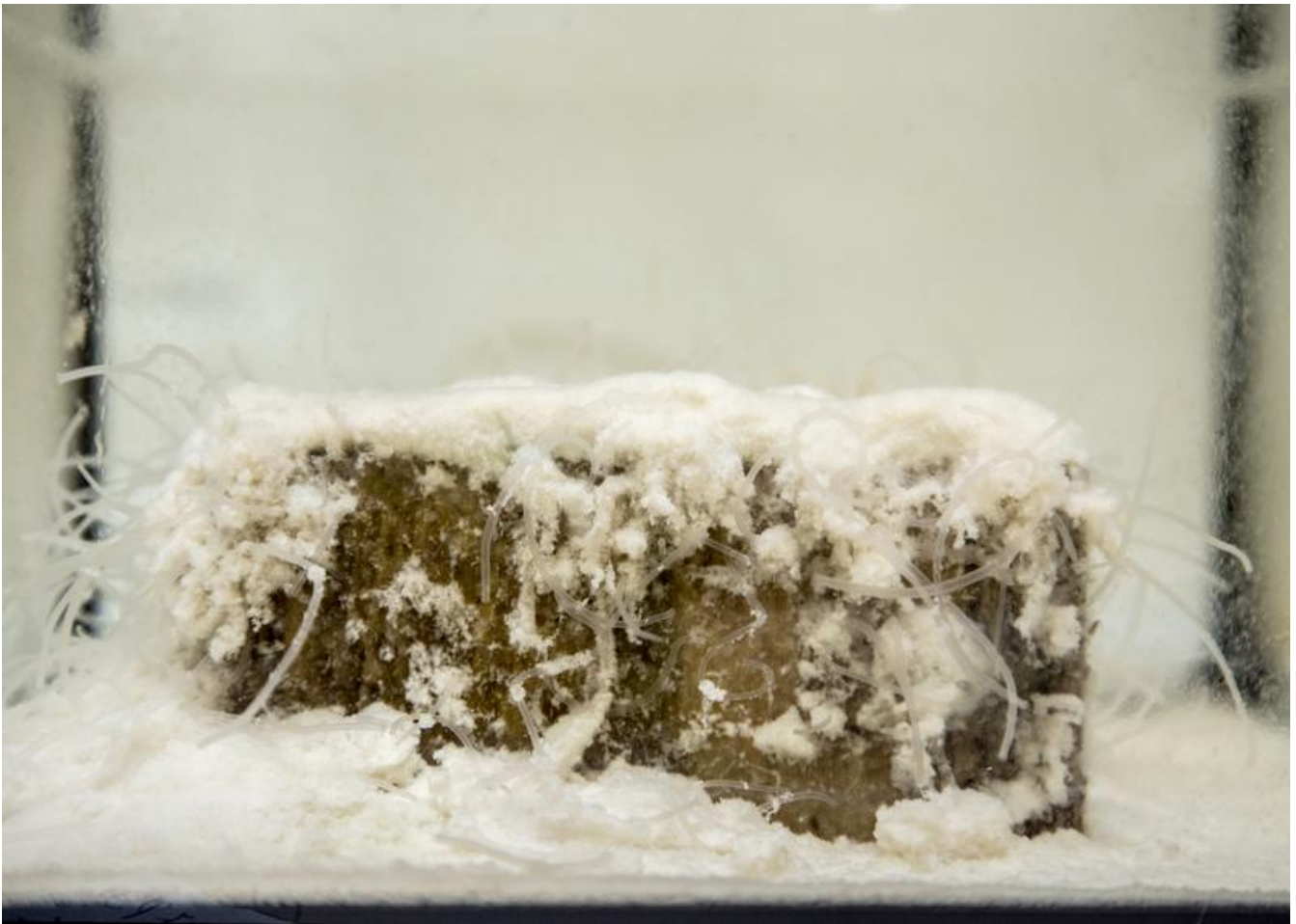
Der schneeartige Belag an den Untersuchungshölzern zeigt Ausscheidungsprodukte der Bohrmuschel Fotos (Uni Rostock/ Thomas Rahr)
