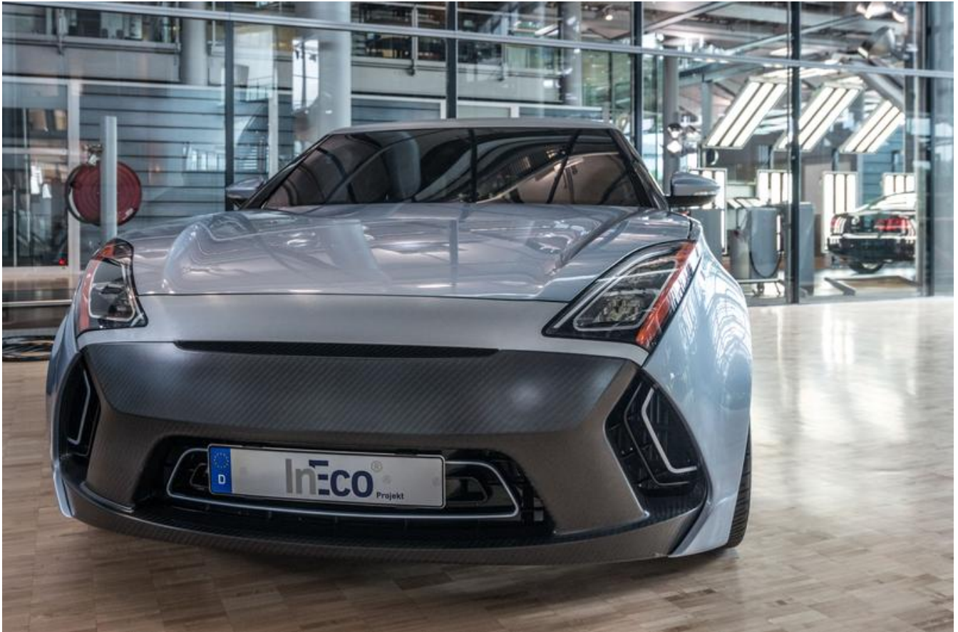
Prototyp eines Elektroautos mit Ultraleicht-Karosserie: Dank eines Mix aus Stahl und Kohlefaser wiegt das komplette fahrbereite Demonstrationsmodell weniger als 900 Kilogramm. TU Dresden
