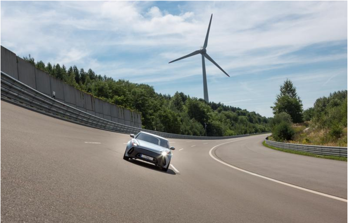
Prototyp eines Elektroautos mit Ultraleicht-Karosserie: Dank eines Mix aus Stahl und Kohlefaser wiegt das komplette fahrbereite Demonstrationsmodell weniger als 900 Kilogramm. TU Dresden
