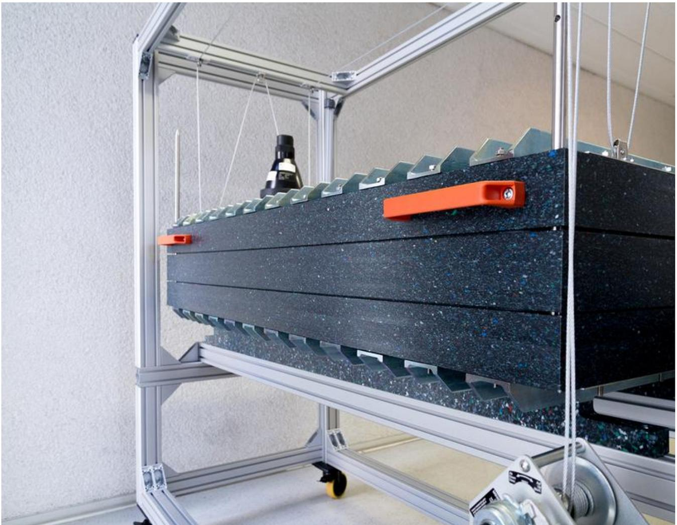
Die Elektrolysezelle ePhos<sup>®</sup> gewinnt Stickstoff und Phosphor rein elektrochemisch.
