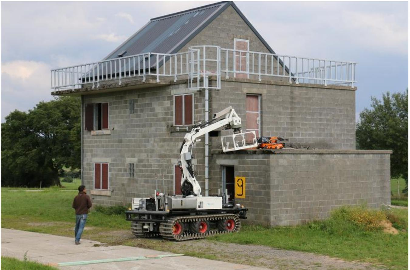
Der kleine Roboter SUGV wird während eines ICARUS-Projekt Tests von dem großen Roboter LUGV auf einem zerstörten Gebäude eingesetzt.
