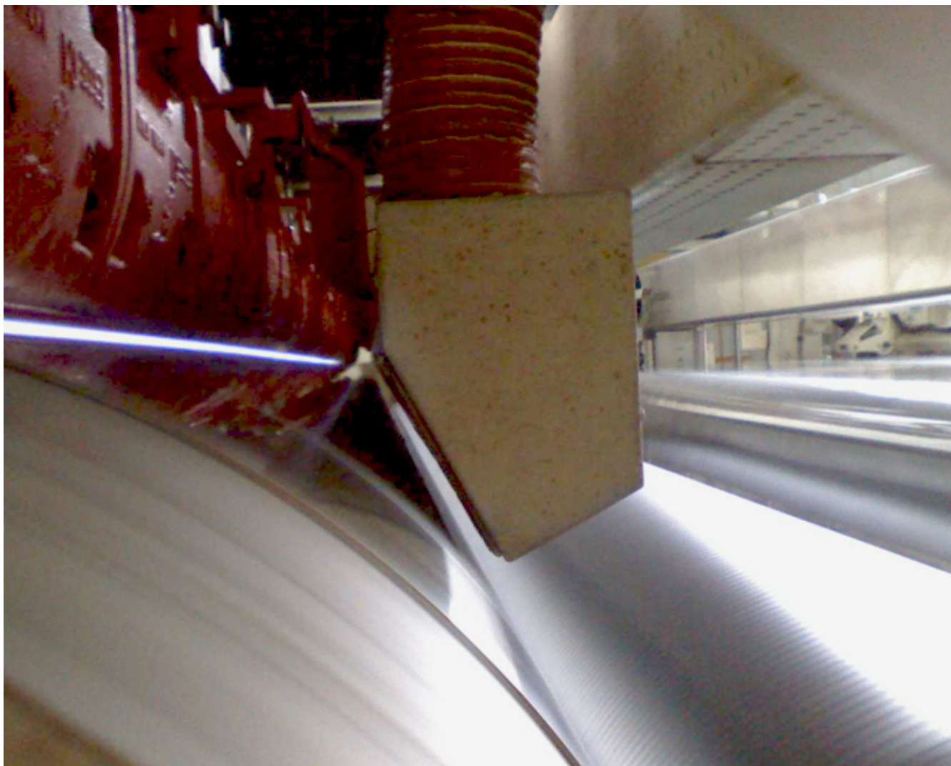
Eine Anlage zur Flammenbehandlung in Betrieb. esse CI
