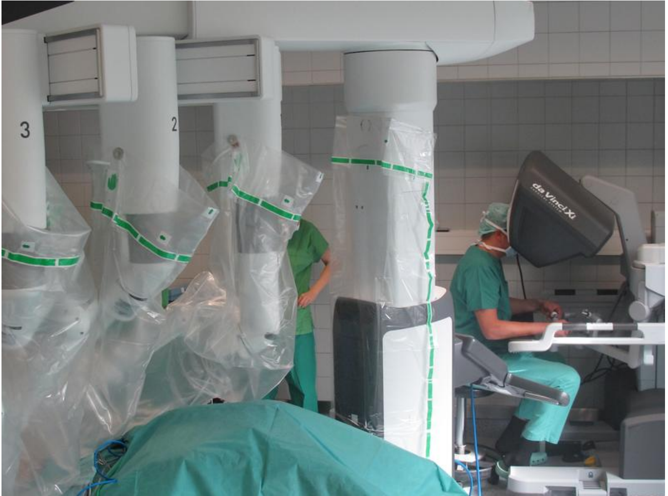
Links die vier Arme des „da Vinci Xi“-Roboters, rechts die Konsole des Operators. Asklepios
