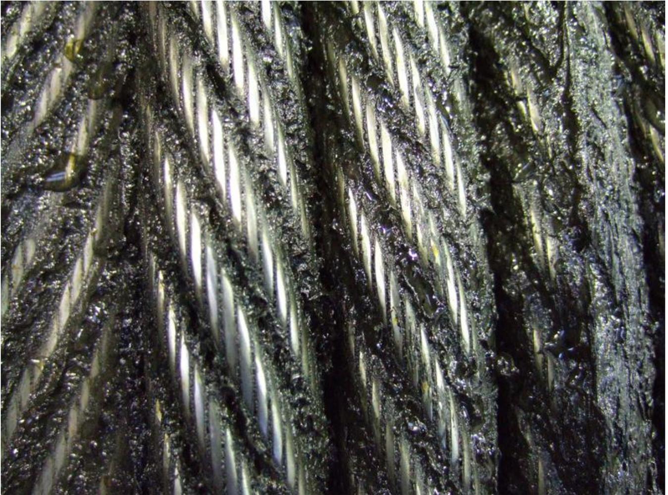
Stahlseil auf Seilwinde: Frisches Fett ist goldgelb. Wird es schwarz, liegt das hauptsächlich an den Stahlpartikeln, die sich durch den Abrieb darin sammeln.
