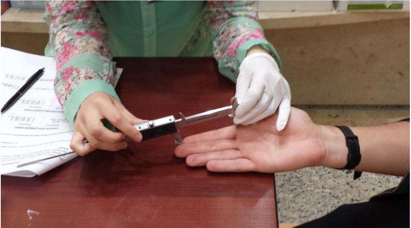
Direkte Messung der Fingerlängen mittels elektronischer Schieblehre
