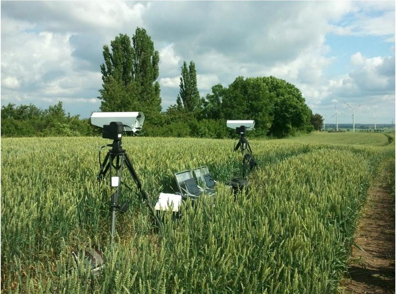
Laserspektrometer zur Messung der Methan- und Ammoniakkonzentration in der Umgebung von Biogasanlagen
