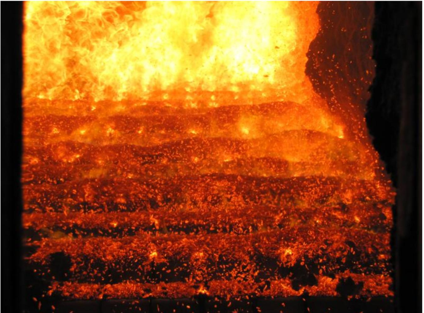
Bioenergie ist eine erneuerbare Energiequelle für Hochtemperaturanwendungen. In Biomassefeuerungen werden bis zu 1.300 °C erreicht.
