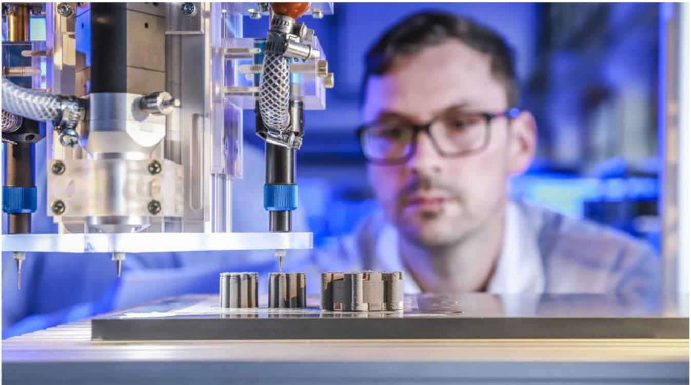
Johannes Rudolph überwacht im Labor den 3D-Multimaterialdruck einer elektrischen Maschine bei dem erstmals Kupfer, Keramik und Eisen gleichzeitig in einem Druckprozess zum Einsatz kommen.
