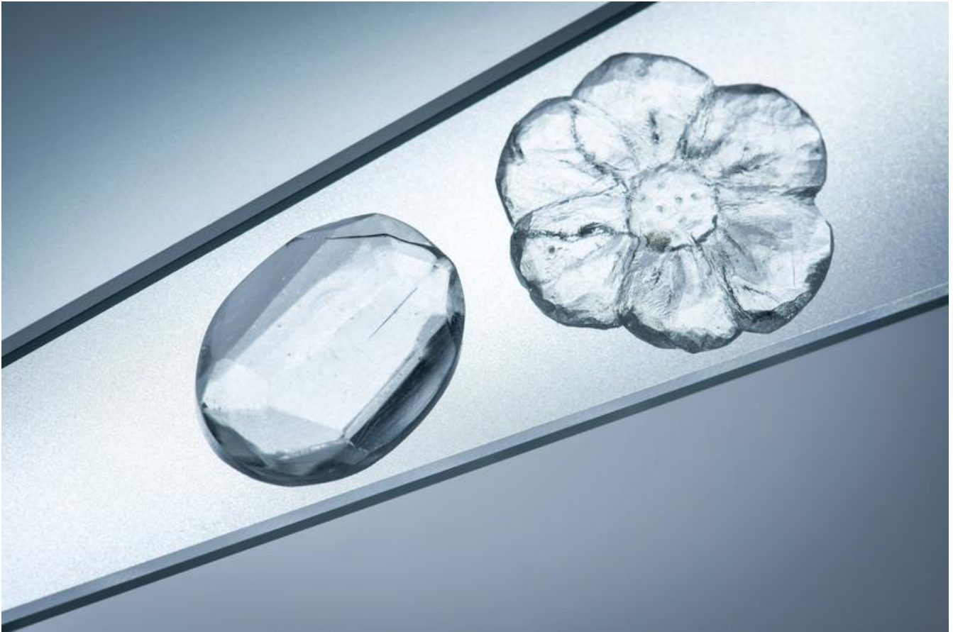
Mit Glassomer können Glaskomponenten wie diese durch Schnitzen hergestellt werden Markus Breig, KIT
