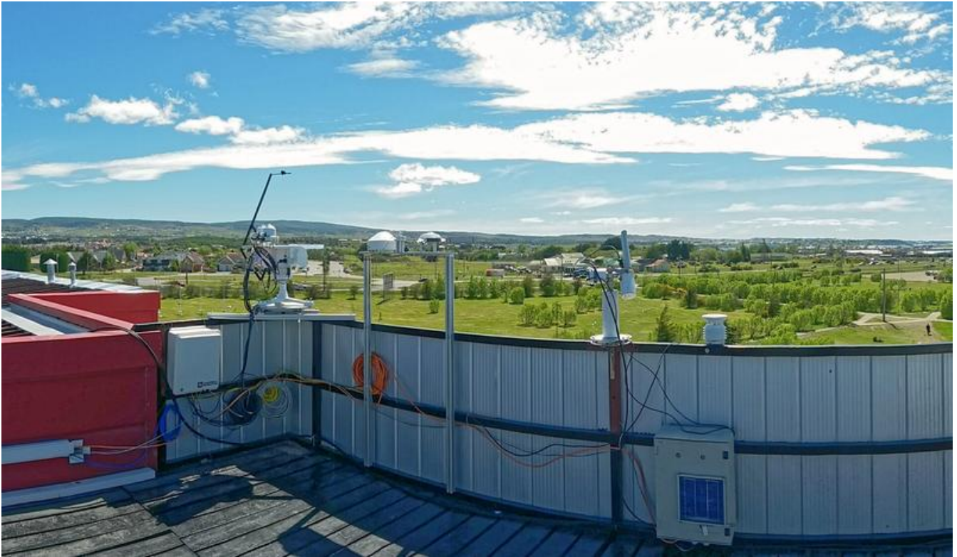
Strahlungsmessgeräte des TROPOS von der UMAG auf dem Dach des Hauptgebäudes der Universität in Punta Arenas. Patric Seifert, TROPOS
