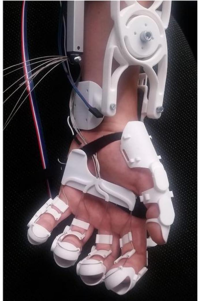
An der Universität Stuttgart wurde ein Hand-Exoskelett entwickelt, mit welchem die Greif-Fähigkeit einer gelähmten Hand wiederhergestellt werden kann.
