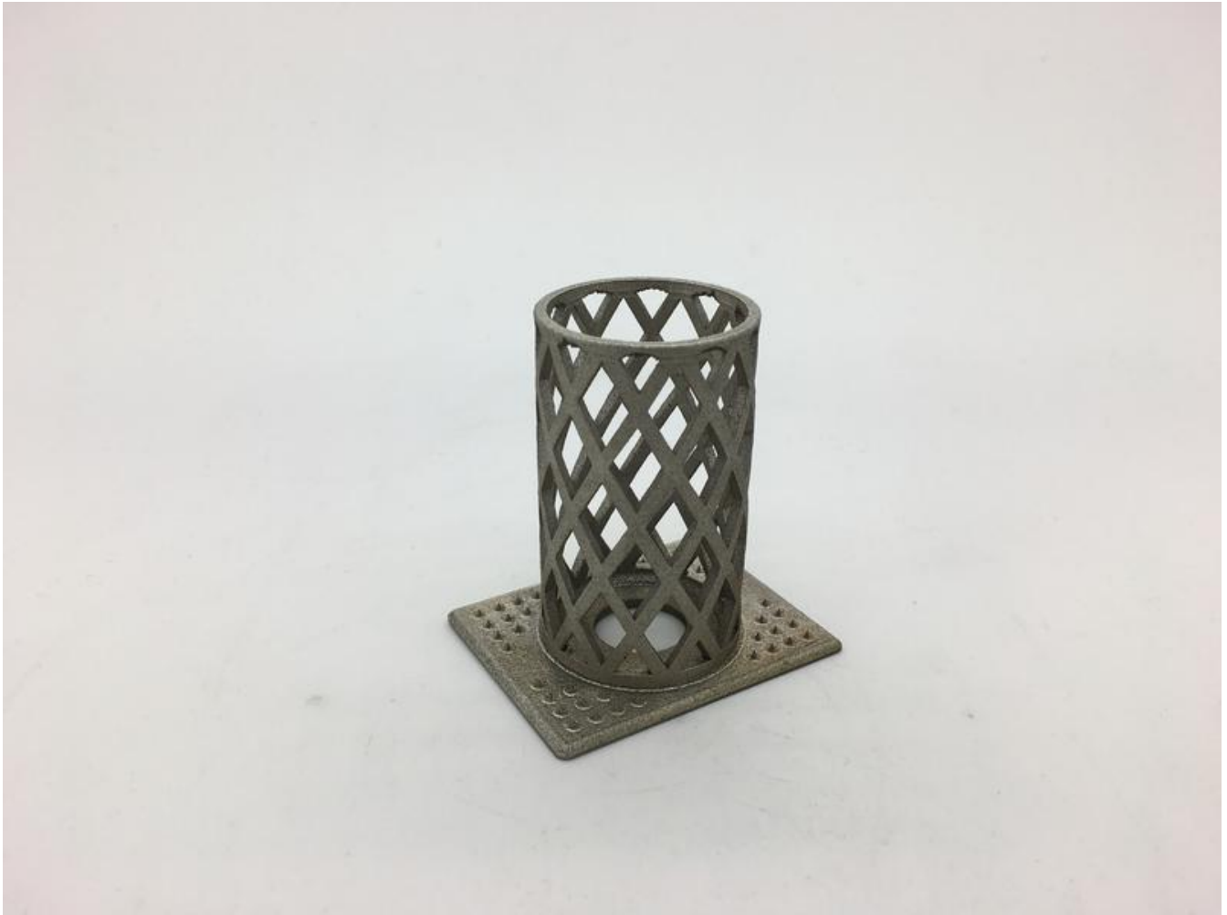
Laminierhülse mit neuartiger Pinstruktur für die formschlüssige Verbindung mit den vorimprägnierten CFK-Fasern. © Fraunhofer IGCV
