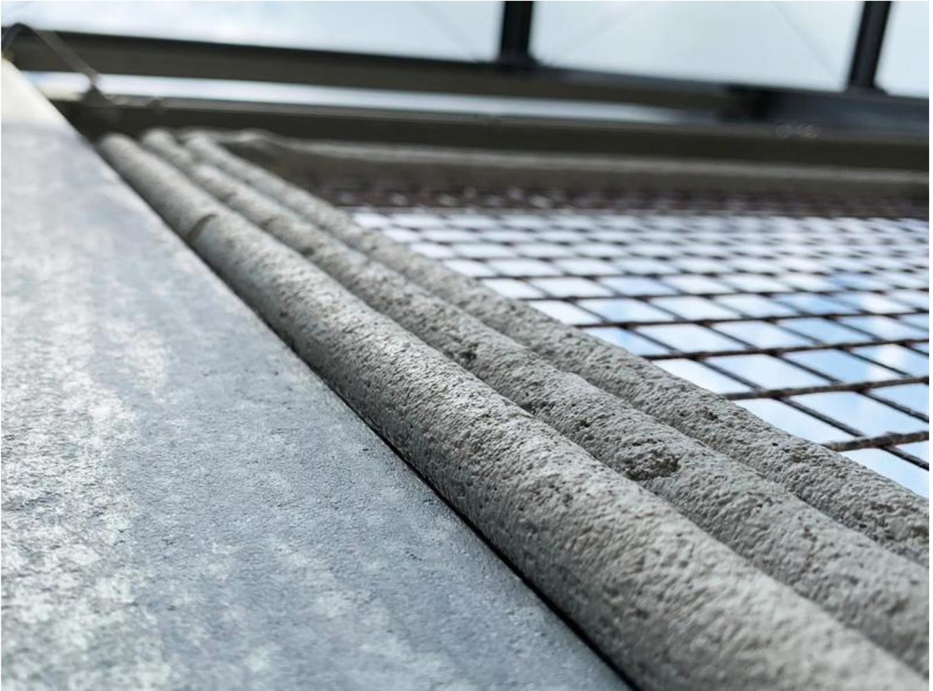
In einem neuartigen 3D-Druckprozess verarbeitet ein Seilroboter zementöses Material.
