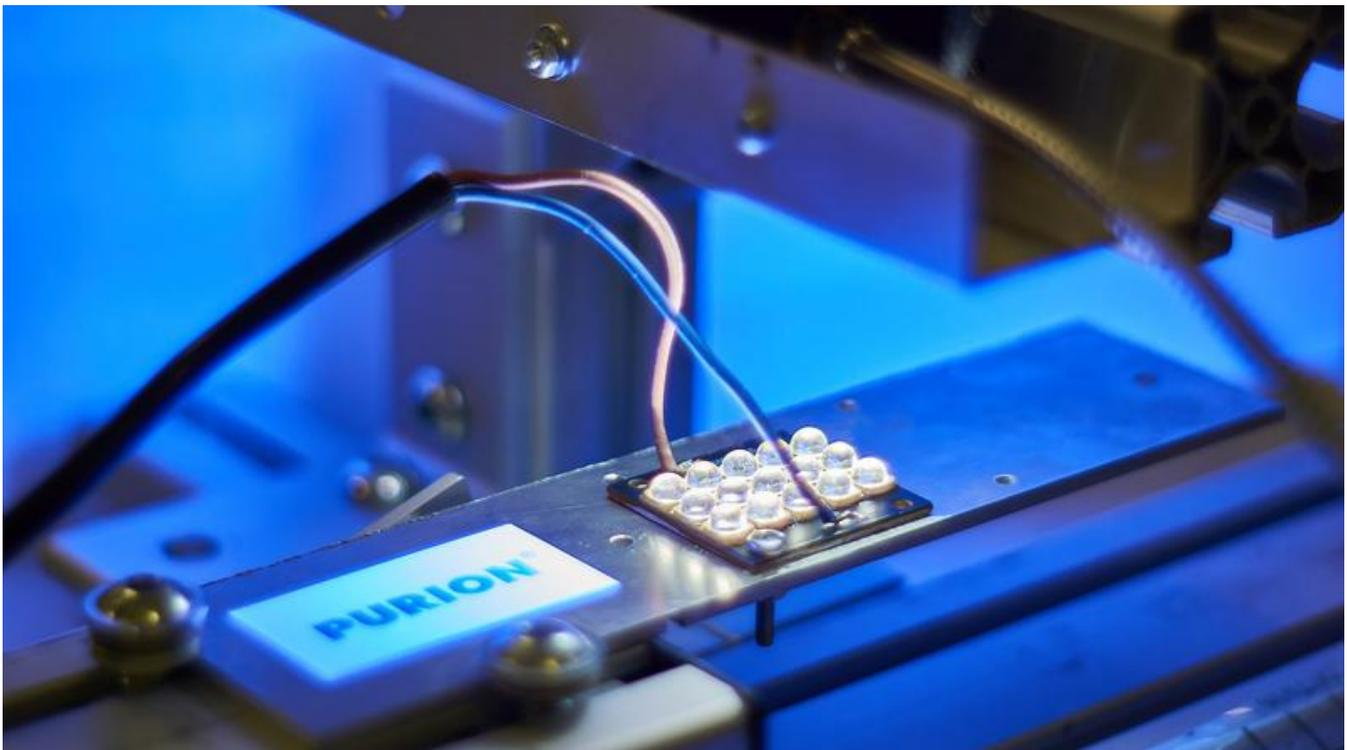
Probeaufbau zum Test von UVC-LEDs.
