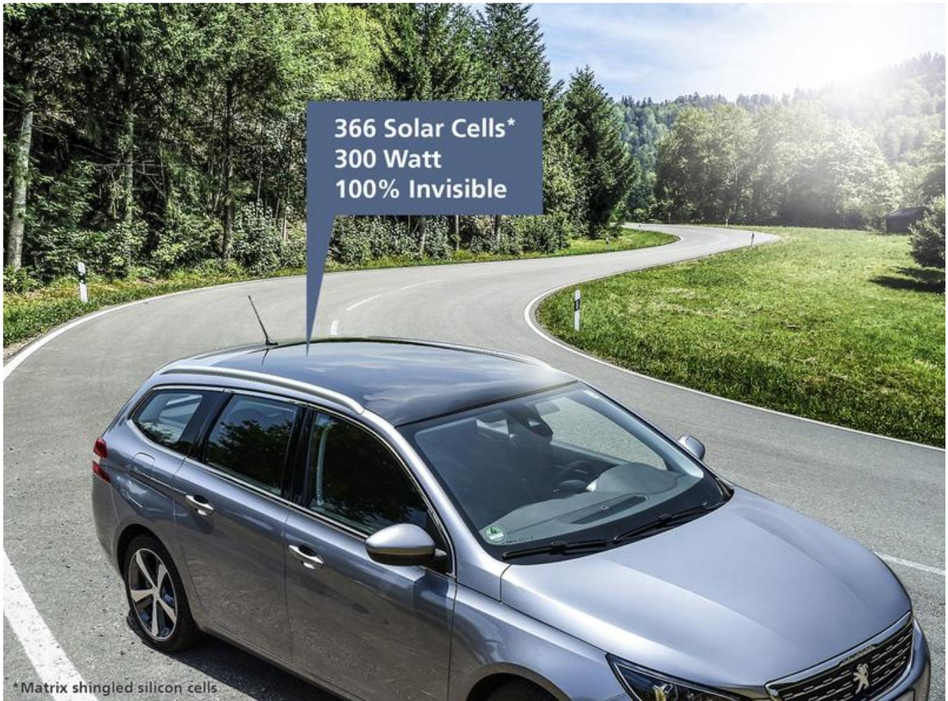
Photovoltaik unsichtbar in ein Autodach integriert: Die Morpho-Color®-Glasbeschichtung ermöglicht eine Anpassung der Farbe an das Fahrzeug.
