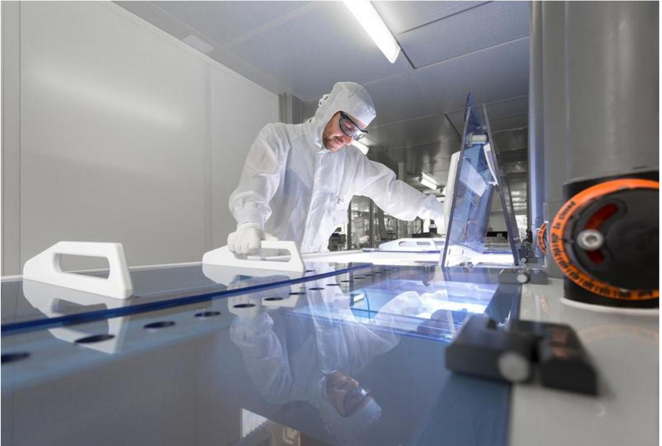
Durchlauf-Ätzanlage zur ozon-basierten Waferreinigung sowie einseitigen Emitterentfernung im »Front End« des Fraunhofer ISE Photovoltaik-Technologie Evaluations Center PV-TEC.
