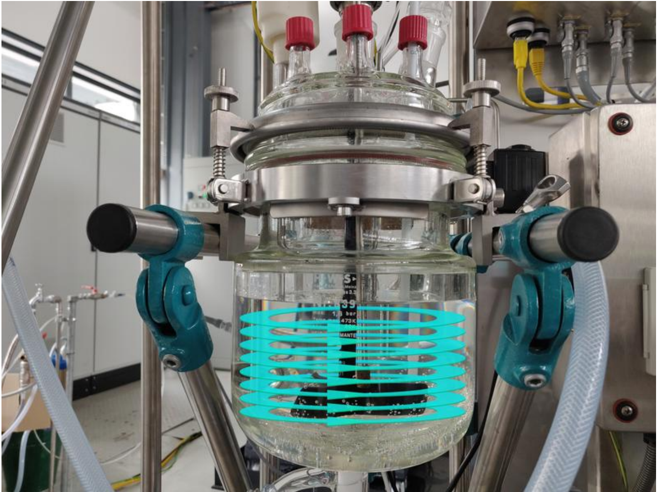
Mockup einer KI-basierten Augmented-Reality-Oberfläche für den Rührreaktor des P2O Labs der TU Dresden". (P2O = Process-To-Order Lab an der TU Dresden) © Professur für Prozessleittechnik/Sebastian Heinze
