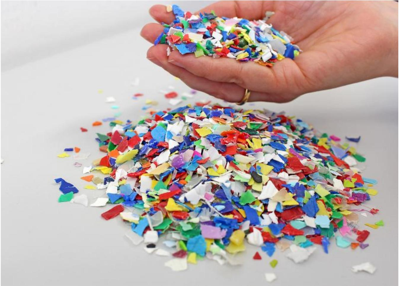
Die Abbildung zeigt Kunststoff-Flakes, die nach weiterer Aufbereitung für neue Produkte wiederverwendet werden können.
