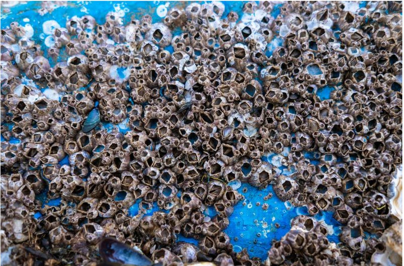
Biofouling am Schiffsrumpf
