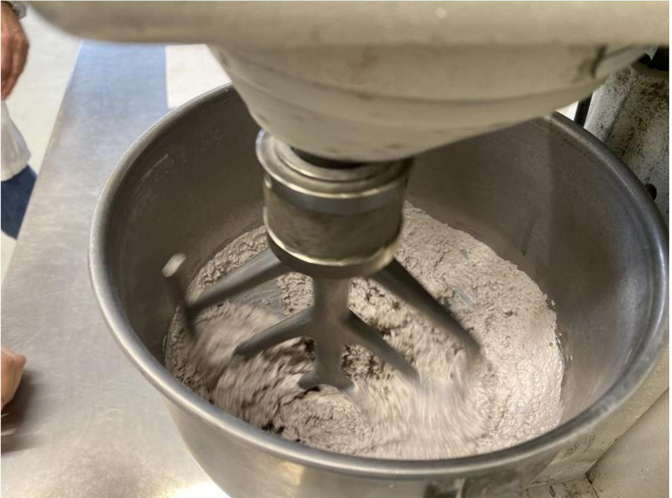
Im Beton-Labor werden die Zutaten für den Öko-Beton gemischt.
