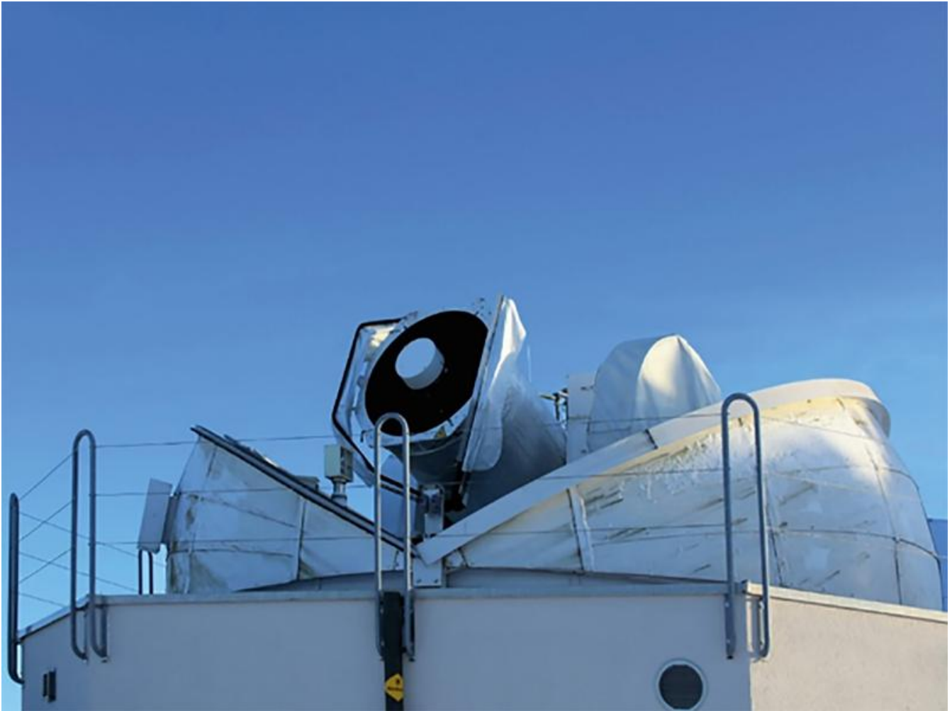
Das Zimmerwalder Laser- und Astrometrie-Teleskop ZIMLAT, das für die Distanzmessung zu Weltraumschrott-Teilen verwendet wird.
