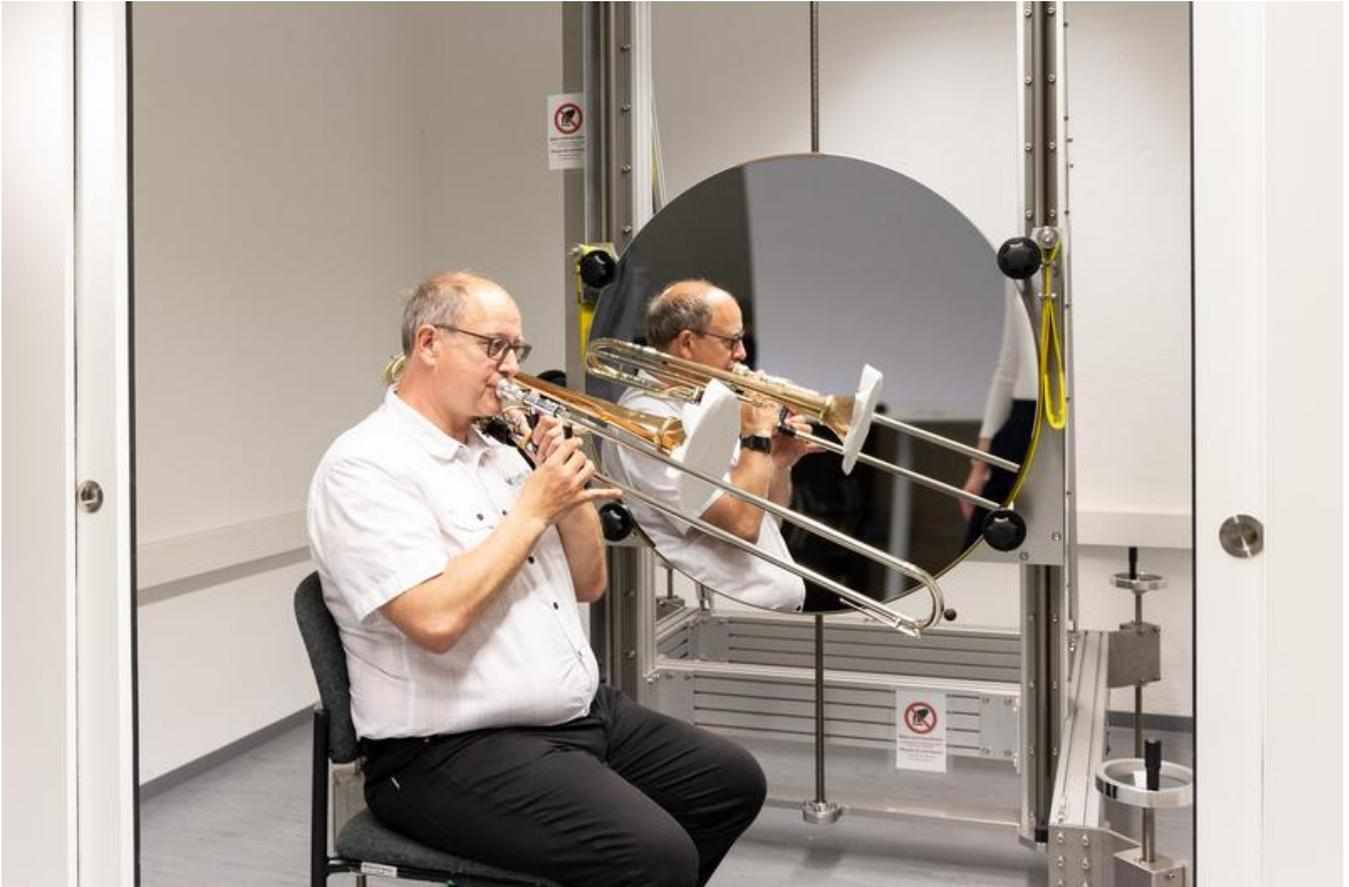
Durch den Einsatz eines einfachen Filters beim Spielen von Blechblasinstrumenten wird die Reichweite der Atemluft stark reduziert.
