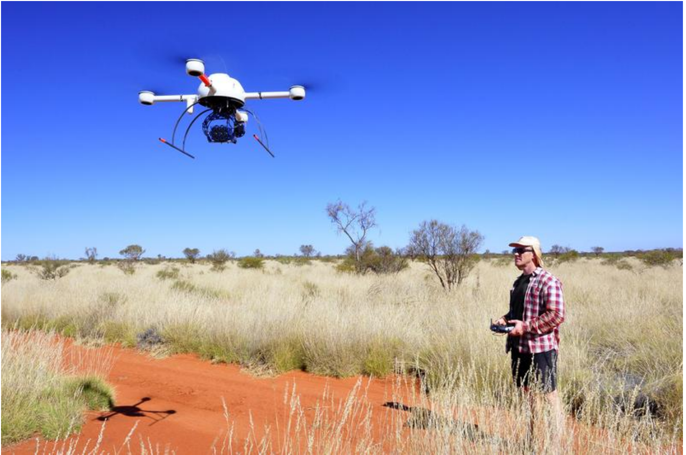
Dr. Stephan Getzin von der Universität Göttingen fliegt einen Quadcopter (Microdrone md4-1000), montiert mit einer Multispektralkamera.
