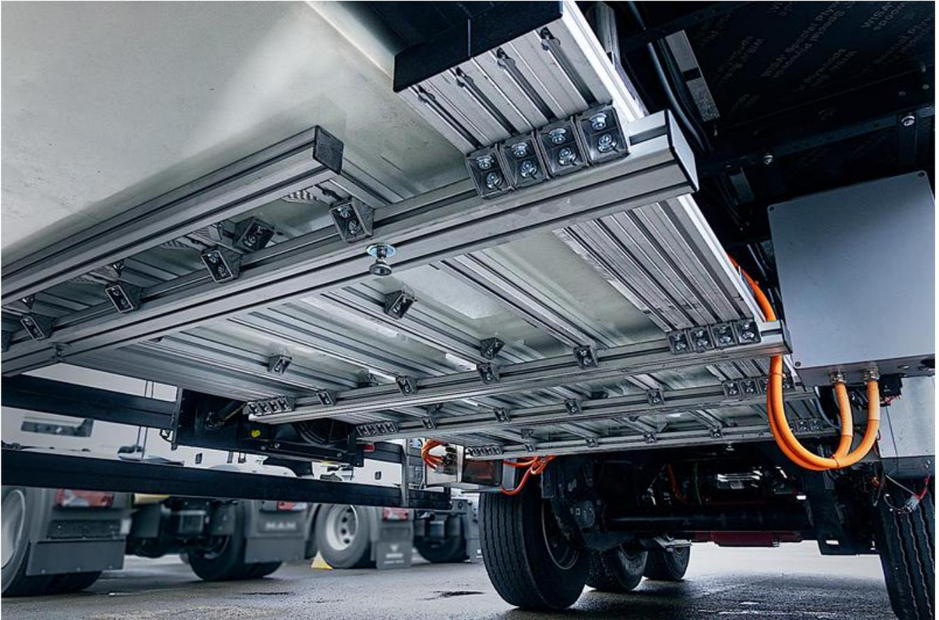
Leicht und effizient: Forschende im Fraunhofer LBF haben einen Hochvolt-Energiespeicher für LKW-Trailer entwickelt
