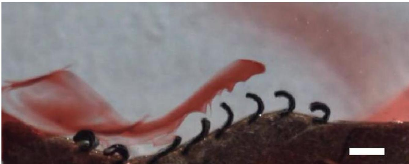
Abbildung 2: Die bioinspirierten Zilien pumpen eine viskose Flüssigkeit (Glyzerin). Die Bewegung wird durch einen roten Farbstoff sichtbar, der sich langsam nach rechts ausbreitet. Maßstabsbalken, 1 mm.
