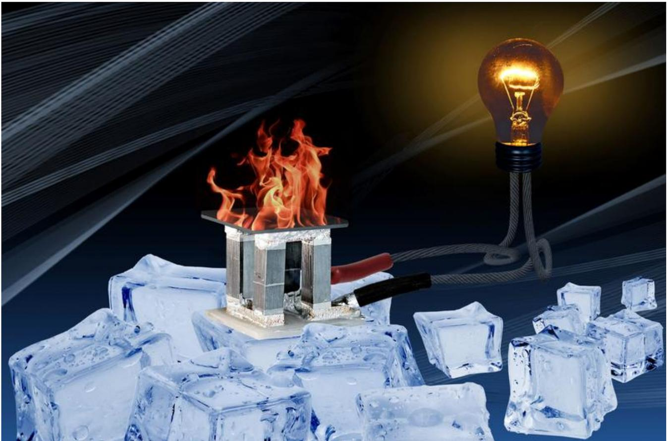
Ein thermoelektrischer Generator wandelt Temperaturunterschiede direkt in elektrische Energie um
