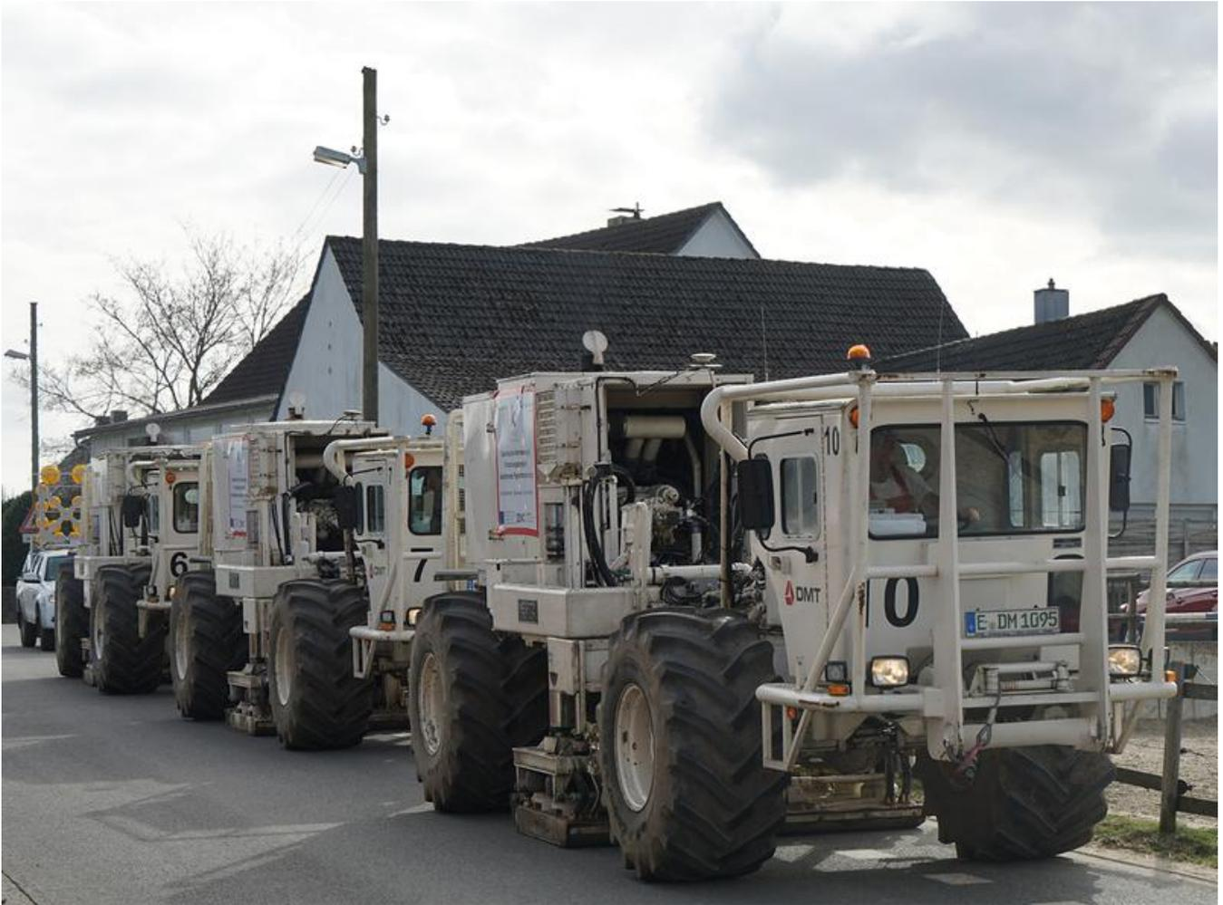
Die Vibro-Trucks verfügen über eine Rüttelplatte, die Schwingungen mit Frequenzen von einigen Hertz in den Untergrund abgeben können.
